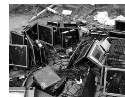
▲港工場の情報機器はすべて、津波による浸水で使用できなくなった。
